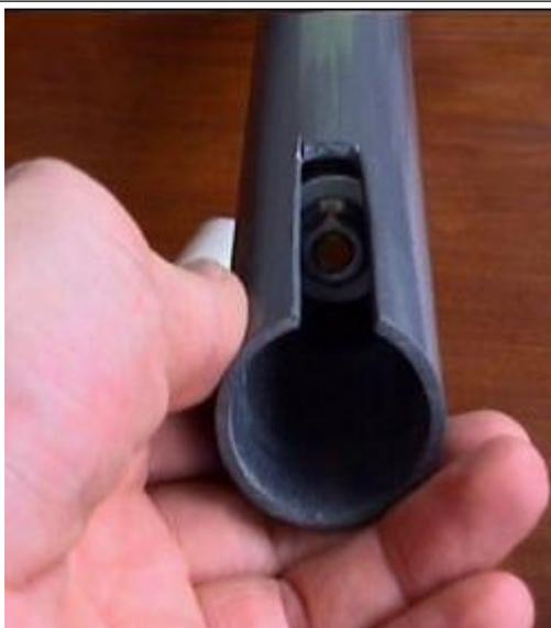
Remarqué le centreur coller au fond de la boîte, c'est de la recup d'un cache en plastique conique qui assure le centrage du PVC, faire un trou dedans permet de le mettre en place avec un tournevis par exemple.
