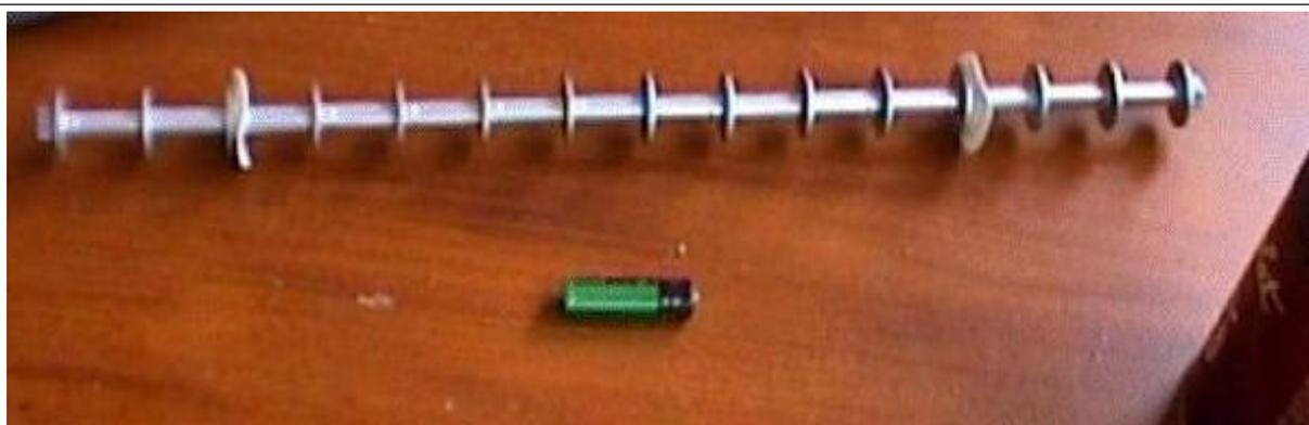
*Détail du bout l'écrou est en acier classique, les rondelles blanches sont la pour calé le tous dans le tube pvc, vous les découpez dans n'importe quoi en plastique un peut flexible (celle-ci sont faites dans un couvercle de pot de nutella) le diamètre est égale au diamètre interne du tube PVC.*
